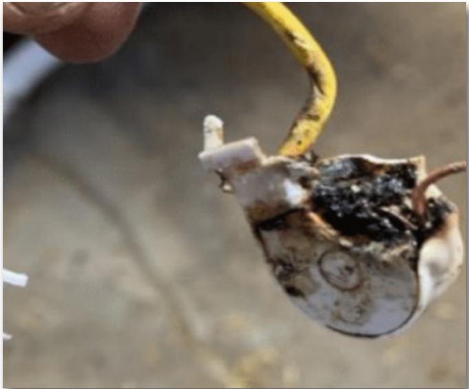
Connecteur de lumière endommagé.
